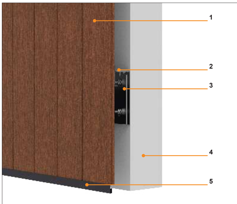
Unión machihembrada longitudinal
